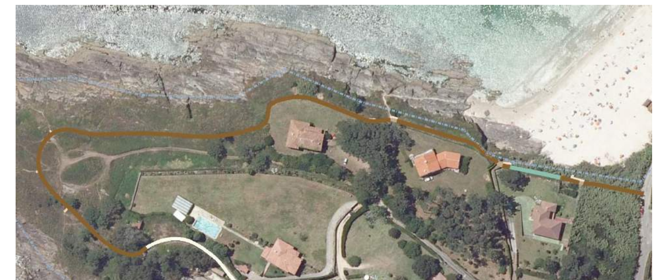
Trazado en planta de la senda de madera (marrón) con escaleras de acceso y senda elevada (verde)
